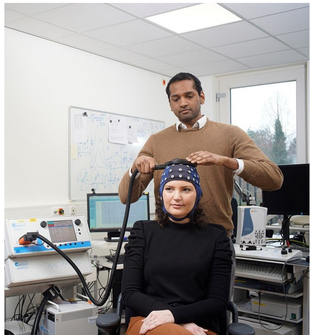
Figuur 1 Transcraniële magneetstimulatie met gelijktijdige opname van het elektro-encefalogram om de corticale prikkelbaarheid in kaart te brengen
